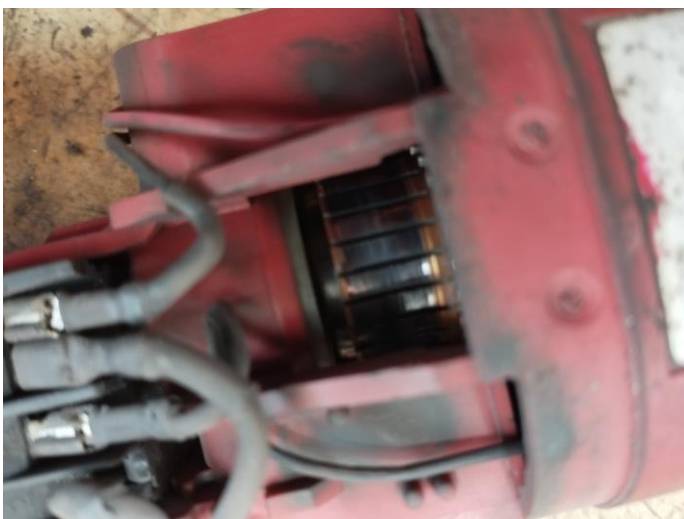
Obr.2 WX12501 v.č. 182533 poškodení komutátor rotora
