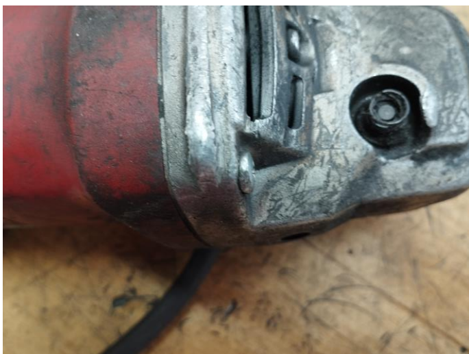
Obr.1 WX12505 v.č.177509 chýbajúce tlačítko aretácie
