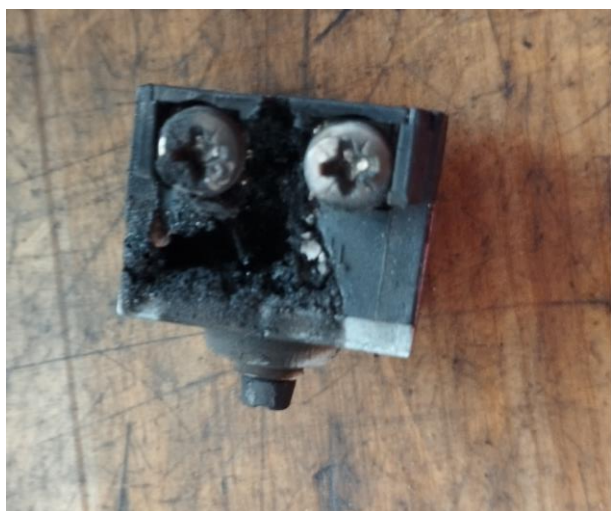
Obr.5 WX12501 v.č. 204398 poškodenie spínača
