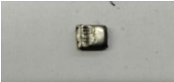
Obr.2 Úlomok z kovovej podložky prevodovky
